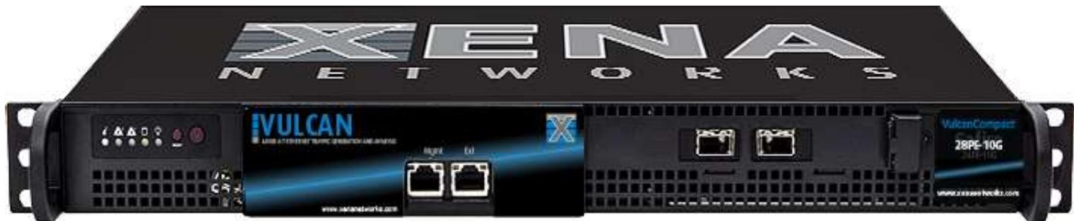
VulcanCompact用于1 & 10千兆以太网设备和网络基础设施的状态流量负载测试，分析和表征。
